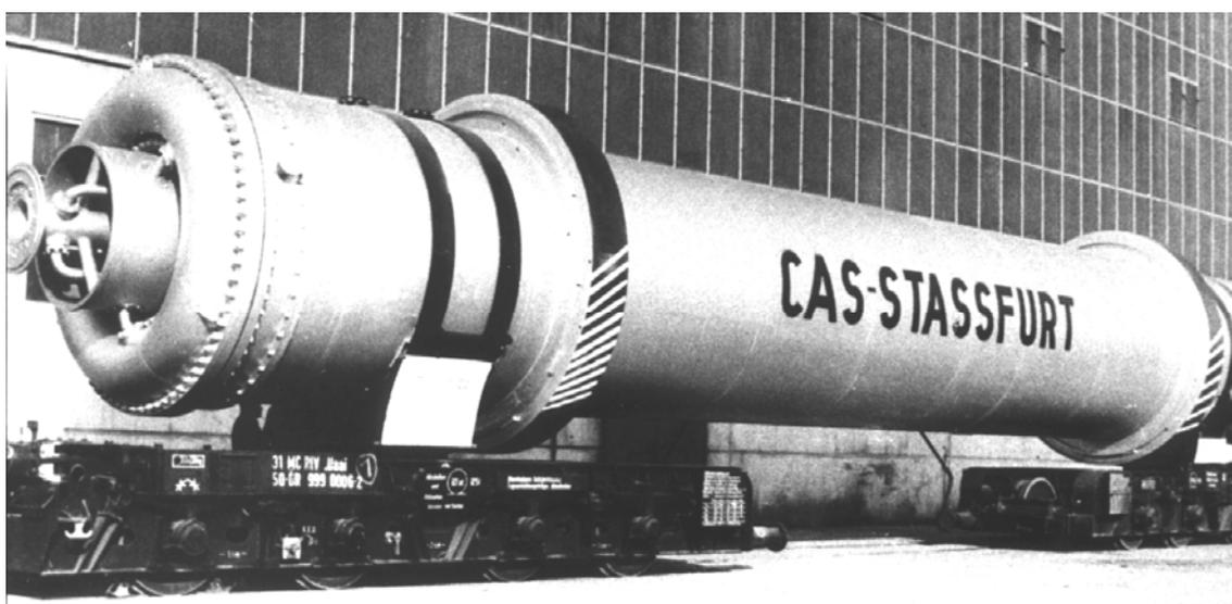
Bild 1 Dampfrohrenkalzinator 400t/d, im Betrieb komplett montiert
