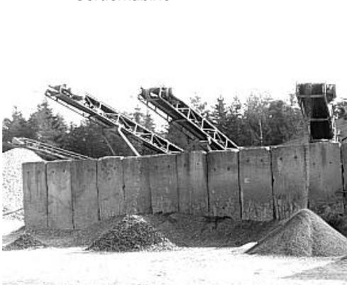
Bild 15 Materialaustrag nach Sortierung und Klassierung
