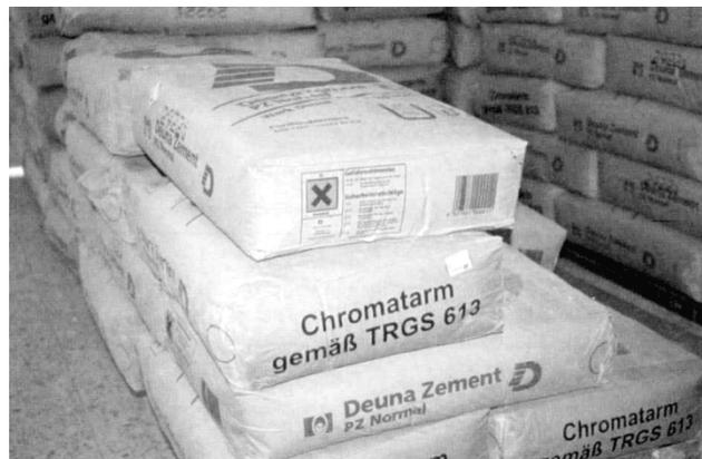
Bild 4 Zementsäcke mit der Aufschrift „Chromatarm gemäß TRGS 613“
