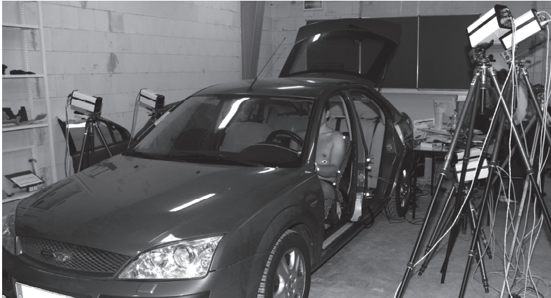
Bild A4: Versuchsumgebung zur experimentellen Analyse von Betätigungsabläufen
