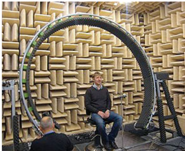
Abbildung 3.1: Messung der AOÜFs [Hear]
