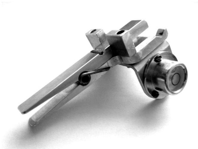
**Abbildung 3.2.1 Die Libelle für die Einstellung des senkrechten Aufsetzwinkels des Fühlers**
