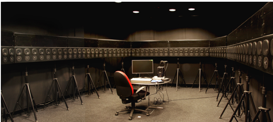
Abb. 1.2: WFS-System des Fraunhofer IDMT im IOSONO-Demoraum [27]
