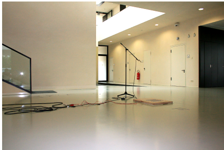
Abb. 7.55: Messaufbau zur Bestimmung des Amplitudenfrequenzganges bei Halbraumabstrahlung im Foyer des Fraunhofer IDMT
