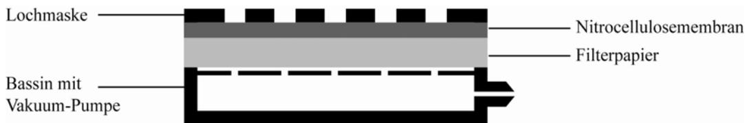
Bild 5.1: Schematischer Aufbau der Blot-Apparatur
