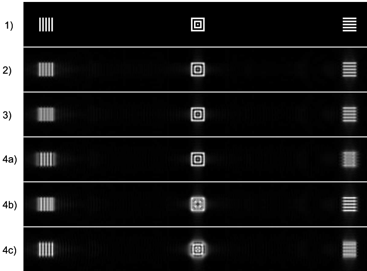
Abbildung 3.3: Simulation der auf k-Vektor Transformation basierenden Rekonstruktion von Hologrammen. 1) Das abzubildende Objekt besteht aus drei Einzelstrukturen in einer Ebene mit jeweils 500 nm breiten, opaken Balken. Der laterale Abstand zwischen den Zentren zweier benachbarter Balkengruppen beträgt 50 \mu\text{m} . Die Wellenlänge der kohärenten Beleuchtung ist mit \lambda = 661 \text{ nm} gegeben. 2) Wird das Hologramm in einem Abstand von 7 mm zur Objektebene aufgezeichnet, sind im rekonstruiertem Objektbild alle Balkengruppen aufgelöst. 3) Ausgehend von einem Hologramm in 3.5 mm Entfernung sind im rekonstruierten Objektbild die Balken der linken Gruppe nicht länger getrennt abgebildet. 4a) Eine nochmalige Halbierung des Detektionsabstands auf 1.75 mm führt dazu, dass nur nach die Balken der zentralen Gruppe getrennt abgebildet werden können. 4b) Mit einer weiteren Ausbreitung der Objektwelle um 0.7 \mu\text{m} sind die Balken der linken Gruppe getrennt. 4c) Die Balken der rechten Gruppe werden 1.6 \mu\text{m} unterhalb der ursprünglichen Objektebene aufgelöst abgebildet.
