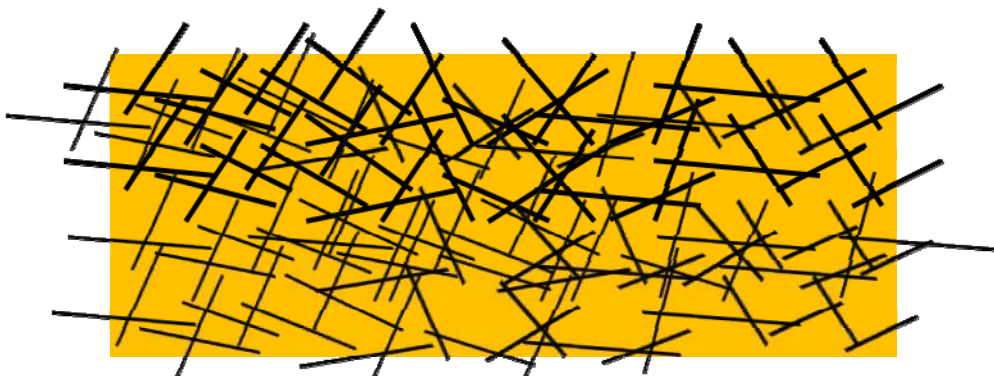
Bild 3-2: Schematische Darstellung eines konventionellen CNT/Sol-Gel Komposits. Derzeitige Herstellungsmethoden erlauben keine vollständige Versiegelung der CNTs. Herausragende Strukturen können als Oxidationspfade für innenliegende CNTs dienen, sodass bei höheren Temperaturen keine Dauerstabilität gegeben ist.
