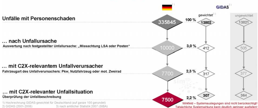
Abbildung 4.7: Wirkfeld Car-to-Infrastructure Kommunikation Rotlichtverstoß-Warnung [WMBK09]
