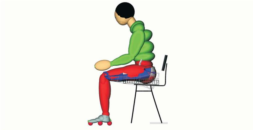
Abbildung 6.3: Modell eines sitzenden Menschen mit FE-Modell des Gesäßes und einer Schaumstoffauflage – Seitenansicht
