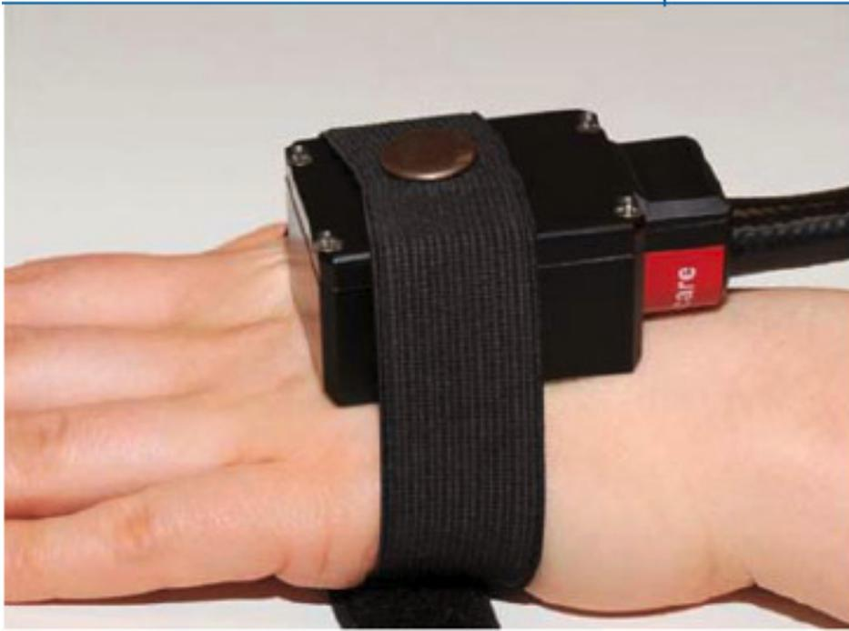
**Abb. 4.4:** Thermode. Die Temperatur der Kontaktfläche mit der Haut wird durch das Stimmulationsprogramm mittels Stromfluss bestimmt. (Quelle: Geber et al., 2009)
