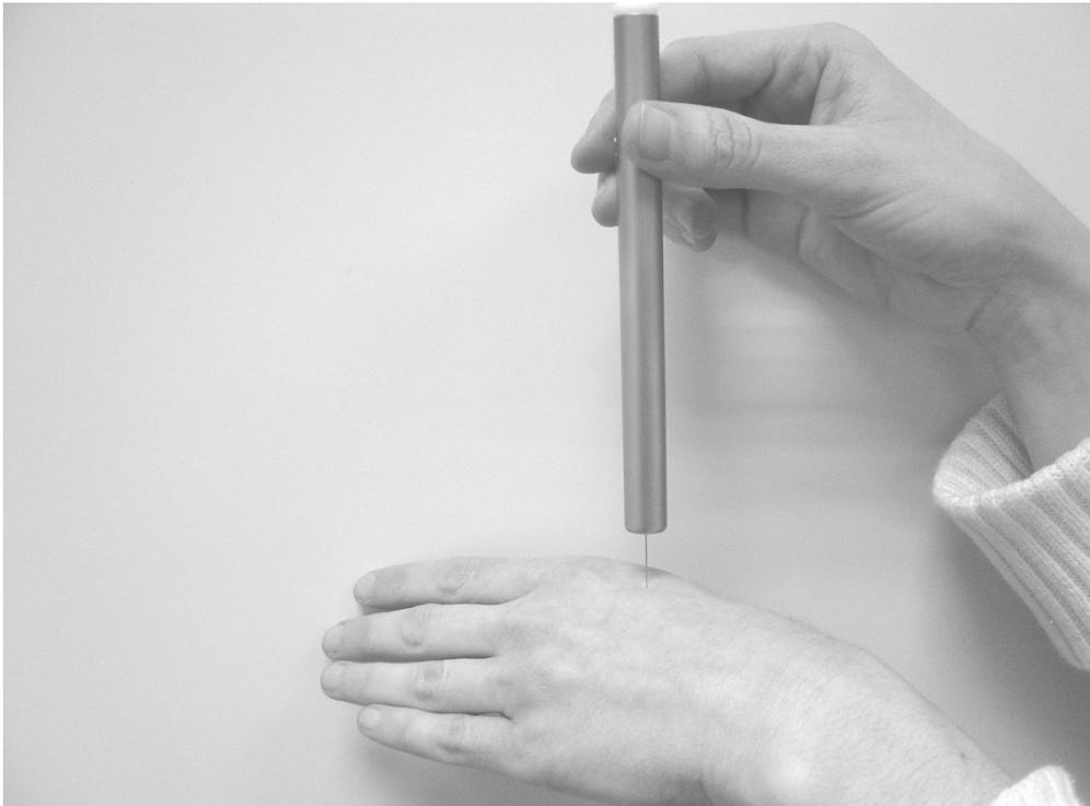
**Abb. 4.7:** Aufsetzen eines Nadelreizstimulators: durch Herunterdrücken der Metallhülle wird mithilfe eines eingebauten Gewichts eine standardisierte Kraft ausgeübt (Quelle: eigene Darstellung).
