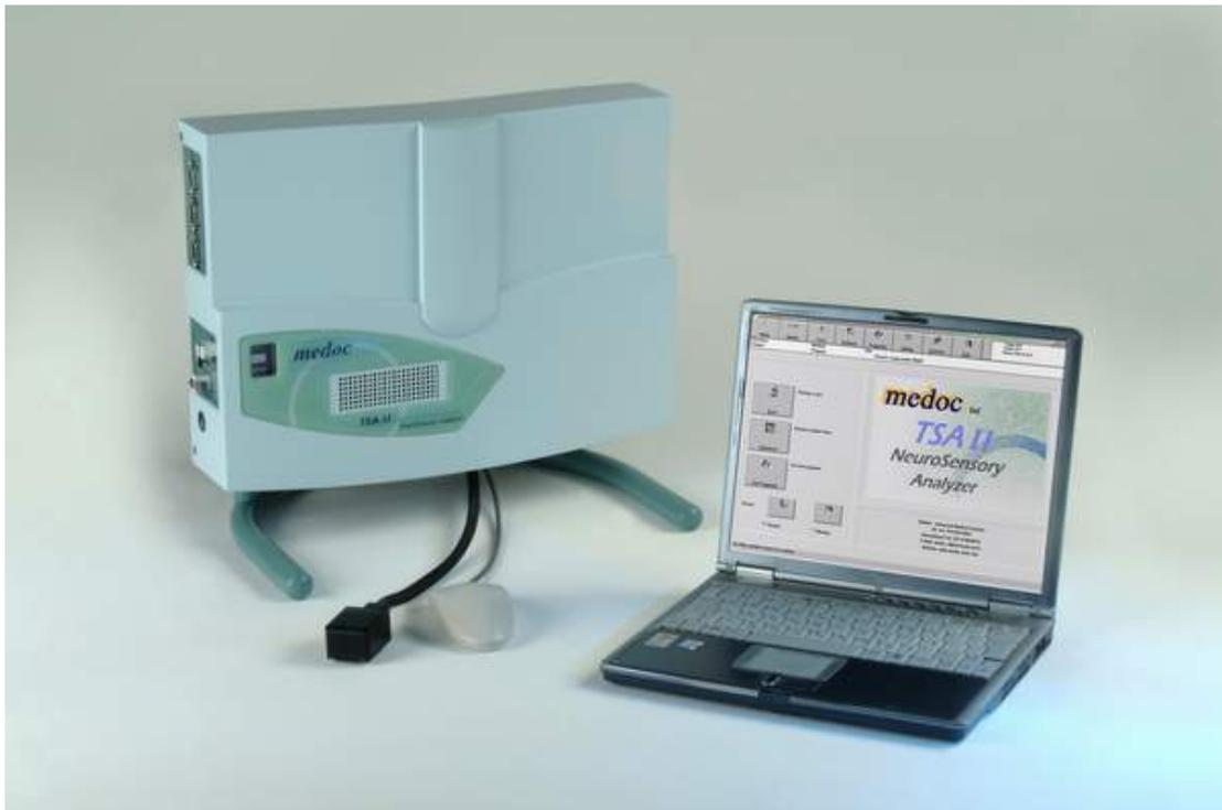
**Abb. 4.3:** Thermostimulator mit Thermode (links) und PC mit Stimulationsprogramm (rechts). Der Thermostimulator und der PC sind durch ein Kabel miteinander verbunden (nicht abgebildet; Quelle: Internetreferenz I).
