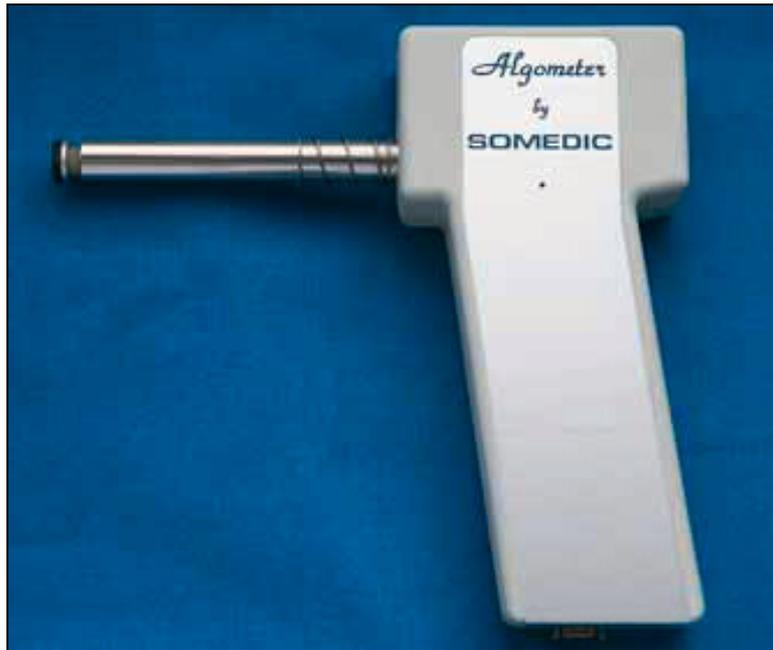
**Abb. 4.12:** Druckalgometer zur Messung der Druckschmerzschwelle (Quelle: Daubländer et al., 2007).
