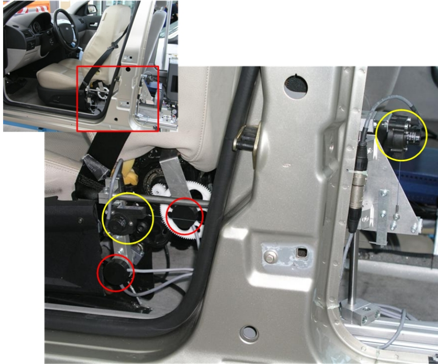
Abbildung 6: Messsystem zur Erfassung der Sitzposition
