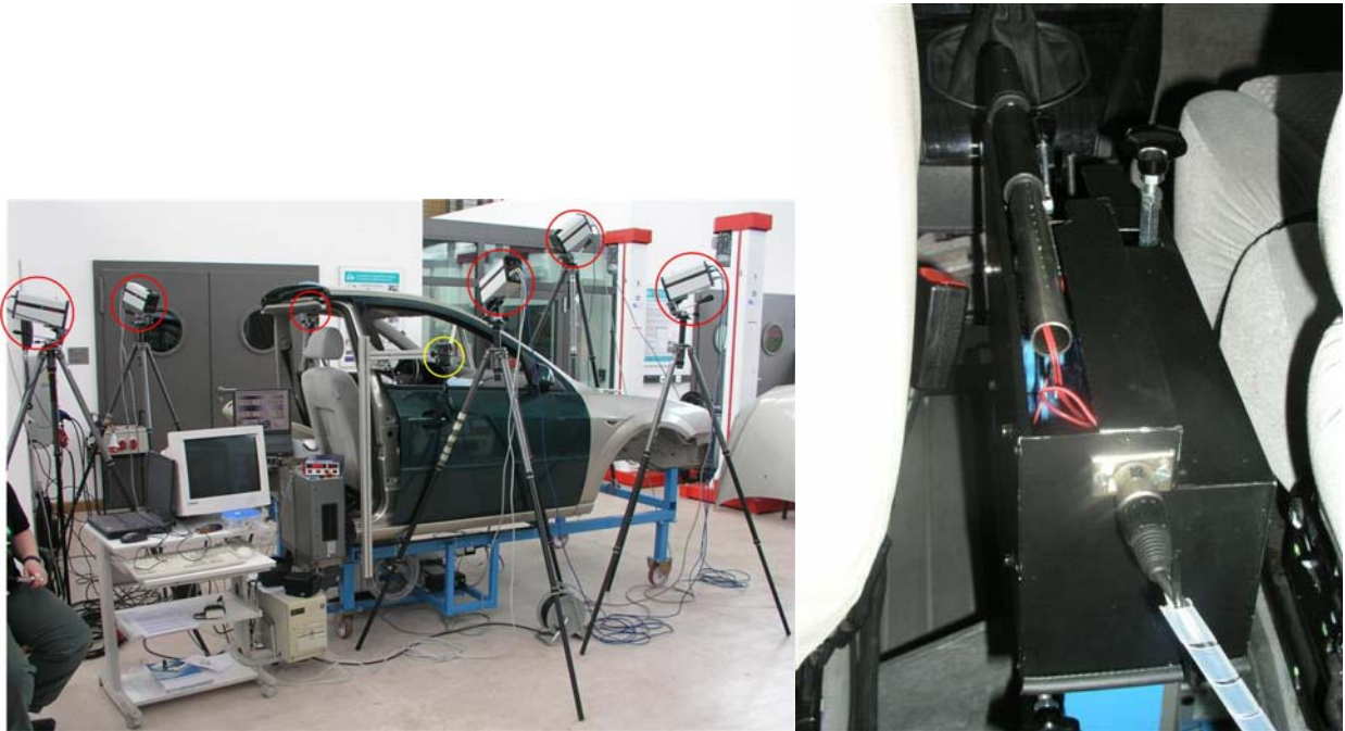
Abbildung 5: Ergonomieprüfstand (links); Eingebautes Bedienelement im Prüfstand (rechts)
