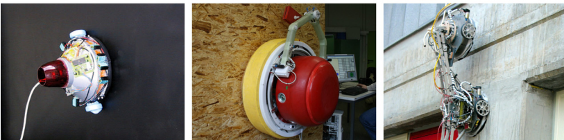
Abb. 12 – Roboter mit strömungsbasierten Greifern. Der Aufbau der Systeme ist ähnlich und wird durch die Vakuumpumpe determiniert. links: ALICIA 1, Mitte: CROMSCI, rechts: bei ALICIA 3 sind drei Greifer gekoppelt. (Bildquellen: [Longo et al. 2006], [Hillenbrand et al. 2008]).
