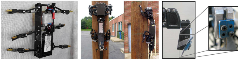
Abb. 14 – Kletterroboter mit eindringenden Greiferstrukturen. Links: Screenbot, Mitte: RISE V3, rechts: Dorn als Greiferstruktur des Roboters RISE 3 (Bildquellen: [Wile et al. 2008], [Haynes et al. 2009])
