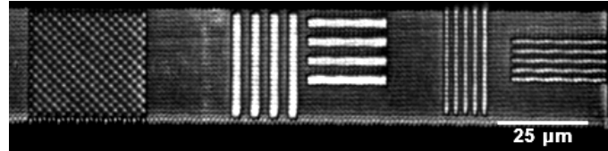
Abbildung 4.8: Mikroskopbild einer Teststruktur zur Bestimmung der Auflösungsgrenze. Die kleinsten Strukturen entsprechen 1,25 \mu\text{m} .
