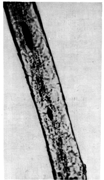
54 Kamelhaar, Grannenhaar mit Markkanalresten, Mikrovergr.: 160fach
