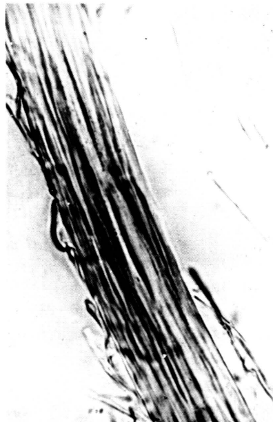
114 Wolle, säuregeschädigt, Fibrillen lösen sich aus dem Verband, Mikrovergr.: 160fach
