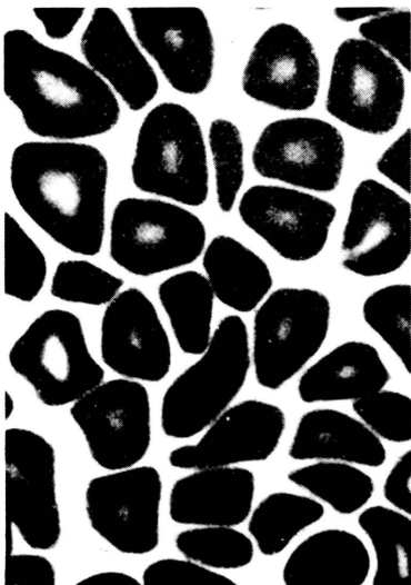
73 Entbastete Seide, Querschnitt, Vergr.: 800fach
