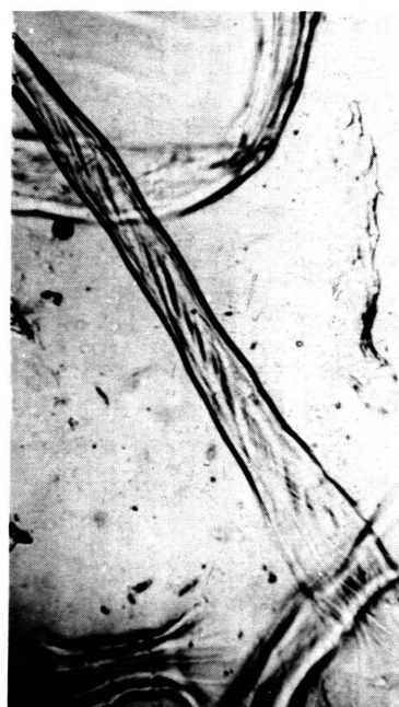
87 Flachsfasern, gebleicht, in Kuoxam, Schrägstreifung, Mikrovergr.: 64fach
