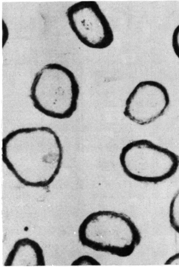
1 Wolle, Querschnitt, Neuseeland, Vergr.: 270fach
