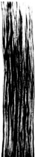
113 Wolle, säuregeschädigt, Schuppenschicht zerstört, Fibrillenschicht liegt frei, Mikrovergr.: 160fach
