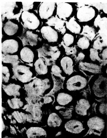
100 Baumwollfasern, Querschnitt, Vergr.: 560fach
