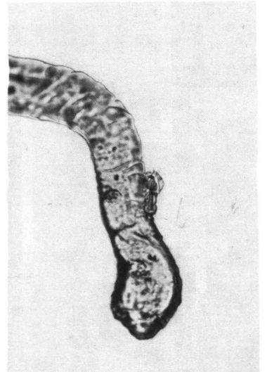
11 Haut- und Gerberwolle, Haarzwiebelansatz, Mikrovergr.: 64fach
