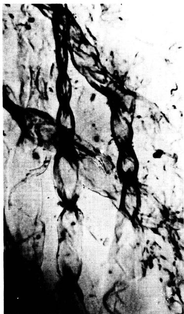
106 Baumwollfasern in Kuoxam, Bildung von "Zellulosebäuchen", Mikrovergr.: 64fach
