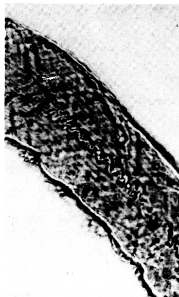
99 Hanffaser gebleicht, in Kuoxam, unterbrochener Proto- plasmafaden, Mikrovergr.: 64fach
