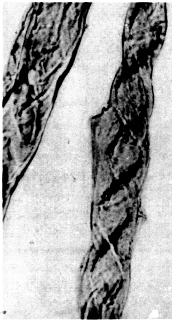
104 Baumwollfasern, ge- bleicht, in Kuoxam, gleichmäßiges Auf- quellen, Quersfältelung, Mikrovergr.: 160fach
