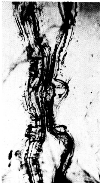
97 Hanffaser in Kuoxam, Schichtung der Zellwand, Mikrovergr.: 64fach
