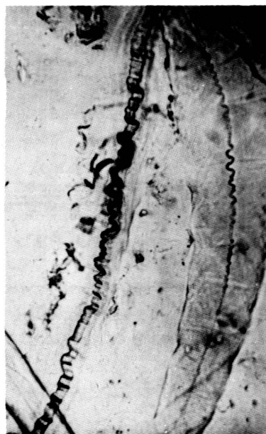
90 Flachsfasern, gebleicht, in Kuoxam, Protoplasmafaden deutlich sichtbar, Mikrovergr.: 64fach
