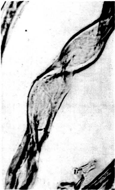
103 Baumwollfaser in Kuoxam, Beginn der Quellung, Mikrovergr.: 160fach
