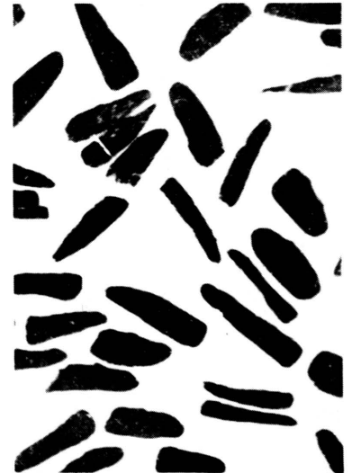
75 Tussahseide, Querschnitt, Vergr.: 380fach
