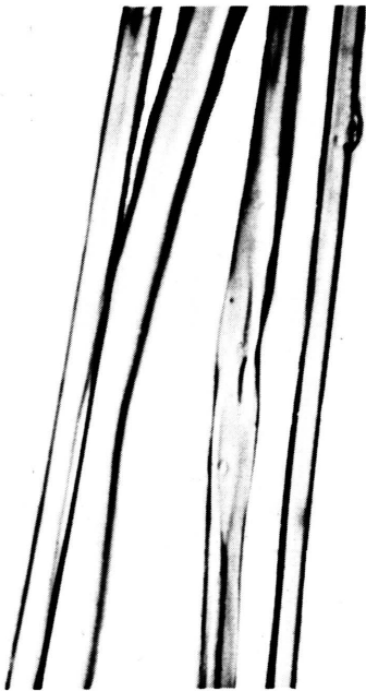
70 Entbastete Seide, Fiber, Mikrovergr.: 160fach
