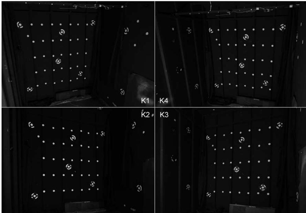
Abbildung 5.6: Aufnahmen eines Passpunktfeldes an der Wand des IM mit Kamera K1 bis K4.
