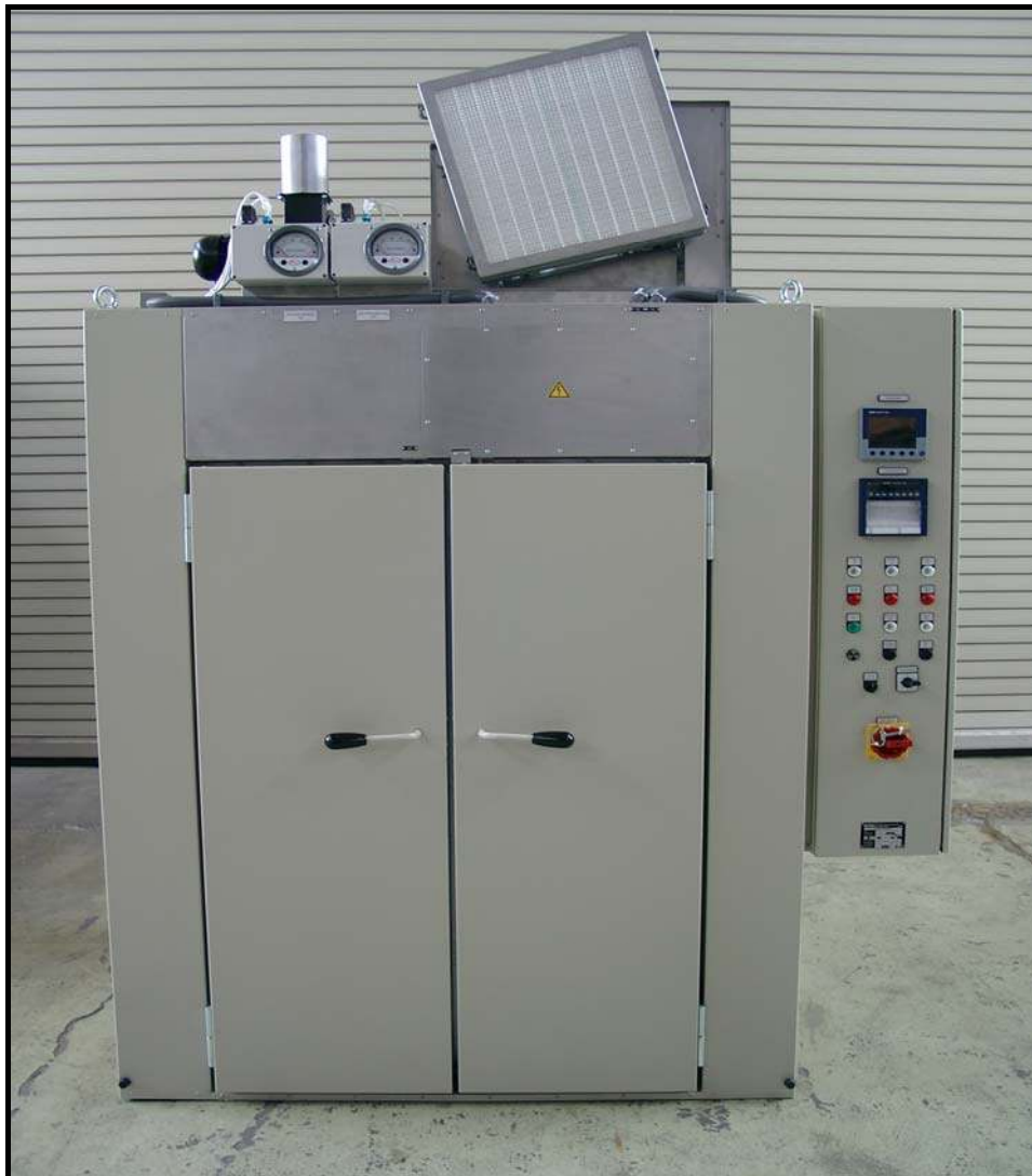
Abb. 1 KU Ofen mit Wärmetauscher nach DIN 1539 [12]
