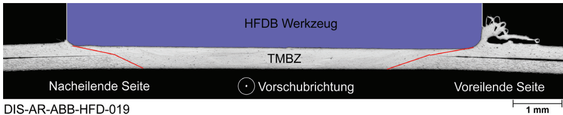
Abbildung 32: HFDB Probe HFD.018 Fügeebene mit 2-facher Vergrößerung aufgenommen mittels Lichtmikroskop; geätzt; AA 7075 oben, AA 2024 unten; Blickrichtung ist in Vorschubbewegung des HFDB Werkzeugs: ausgeworfenes plastifiziertes Material in Spanform auf der voreilenden Seite des HFDB Werkzeugs links, leichter Grat auf der nacheilenden Seite des HFDB Werkzeugs rechts im Bild; Position und Ausdehnung der HFDB Reibfläche in blau skizziert.
