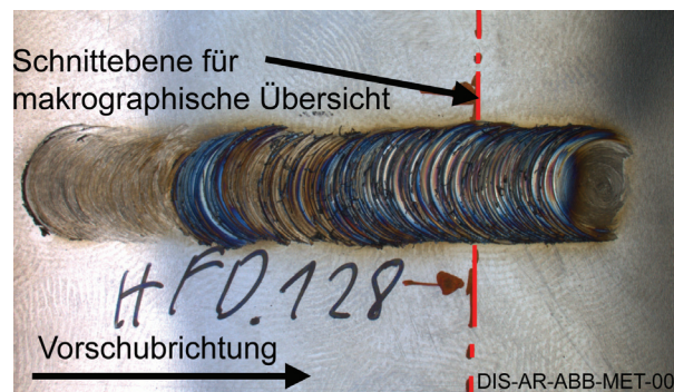
Abbildung 41: Oberflächenstruktur der HFDB Probe HFD.128 mit 1.4301 als Reibpartner sowie AA 7075 als Fügepartner; WRe als Werkzeugwerkstoff; Breite der Naht 8 mm, Länge 40 mm; Abdruck des Werkzeugs nach dem Abheben vom Reibpartner rechts im Bild; rot markierte Linie ist Schnittlinie für makrographische Übersicht in Abbildung 42.
