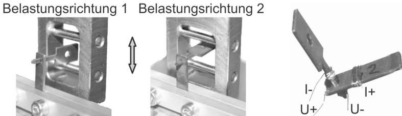
**Abbildung 4.2.38:** Bilder der mechanischen Halterung und Belastung (Links, Mitte) sowie die Kontaktierung zur Widerstandsmessung (Rechts).
