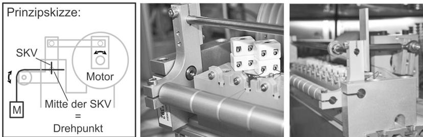
**Abbildung 3.1.6:** Prüfstand 2: Prinzipskizze und Bilder des Aufbaus zur Belastung von Schneid-Klemm-Verbindungen für dünne Lackdrähte.
