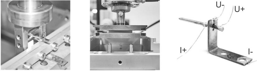
**Abbildung 4.1.4:** 1,5-mm-SKV: Dargestellt sind die Halterung und die Werkzeuge zur mechanischen Wechselbelastung (Links und Mitte) sowie die Kontaktierung zur Widerstandsmessung (Rechts).
