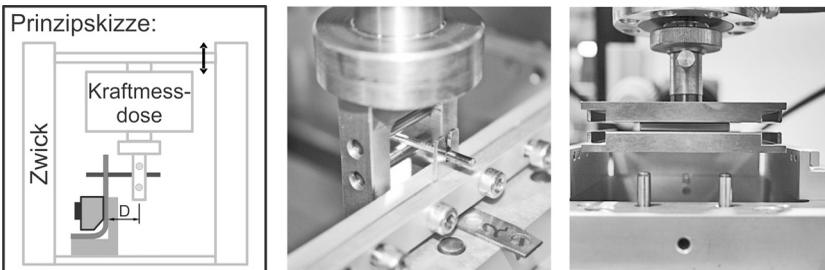
**Abbildung 3.1.1:** Prüfstand 1: Prinzipskizze und Bilder der Werkzeuge zur definierten Belastung einzelner (Mitte) und mehrerer (Rechts) elektrischer Verbindungen.
