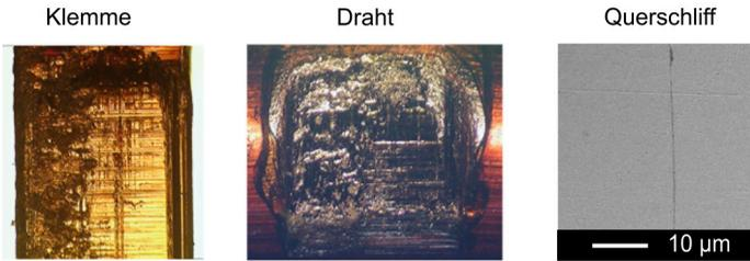
Schädigungsverlauf bei einer Auslenkung von  $A = 2$  mm
