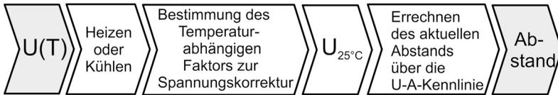
**Abbildung 6.2.9:** In vier Schritten von der Sensorspannung zum Abstand des Messobjekts.
