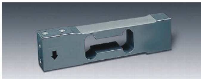
Abbildung 1.1: DMS-Wägezelle aus Aluminium für einen Lastbereich bis 100 kg mit 6 000 Teilungswerten für eichfähige Anwendungen. Quelle: Sartorius AG
