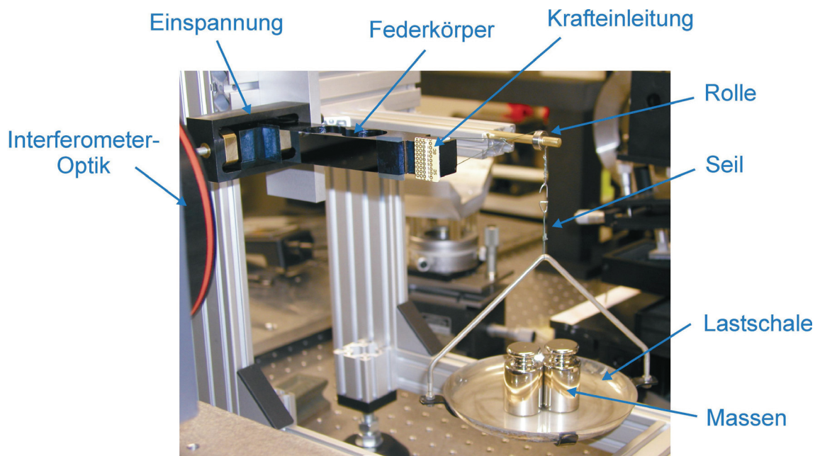
Abbildung 5.3: Versuchsaufbau zur optischen Verformungsmessung eines Si-Federkörpers unter Last.
