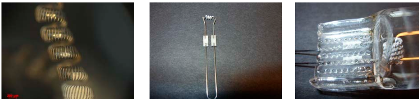
Bild 2: Ausschnitt aus einer ND-Elektrode (links), Elektrode mit Molybdänfolie und W-Draht (Mitte) und in Quarzglas eingequetschtes System (rechts)
