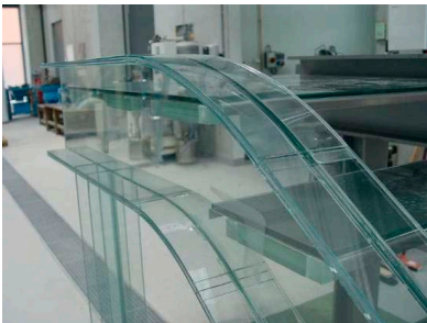
Gekrümmter Bereich einer Treppenwanne aus Glas-Kunststoff-Hybridelementen
