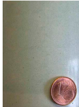
Bild 1: Durch Urformen hergestellte HGB- Oberfläche mit einer Rauheit von < 0,2 \mu\text{m}
