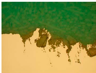
Bild 17: Nachweis typischer nichtmetallischer Verunreinigungen auf der Bruchfläche oder am Schliiff Nichtmetallische Verunreinigungen im Bruchbereich am Querschliiff; 200:1 (9x13)
