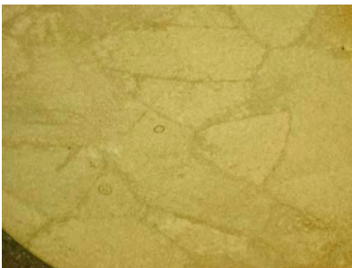
Bild 15/16: Scheinbares Grobkorn bei Betrachtung mit zu geringer Vergrößerung 25:1 (bei 9x13) / Tatsächliches Feinkorn bei ausreichender Vergrößerung 500:1 (9x13)
