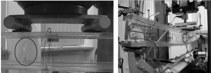
Bild 5: Optische Träger mit Riss im Glas-Stegelement – Vier-Punkt-Biegeversuch
