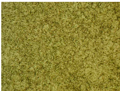
Bild 15/16: Scheinbares Grobkorn bei Betrachtung mit zu geringer Vergrößerung 25:1 (bei 9x13) / Tatsächliches Feinkorn bei ausreichender Vergrößerung 500:1 (9x13)
