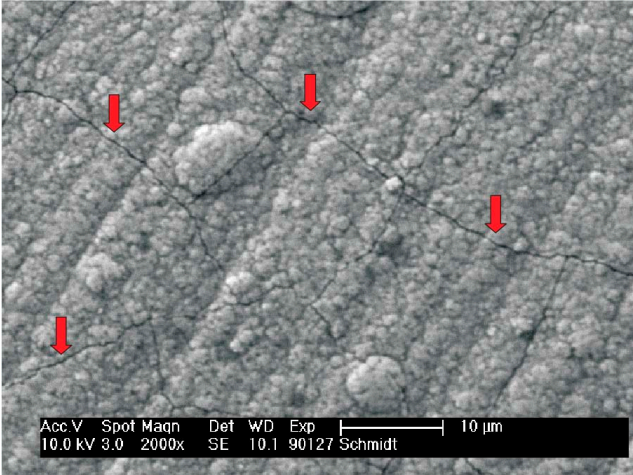
Bild 3: Rißnetzwerk an der Oberfläche
