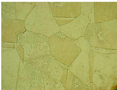
Bild 13/14: Scheinbares Gefüge durch fehlerhafte Ätzung eines austenitischen Werkstoffes; tatsächliches Gefüge von Bild 13
