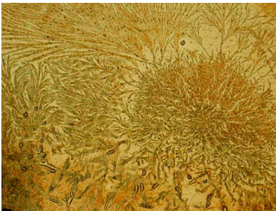
Bild 13/14: Scheinbares Gefüge durch fehlerhafte Ätzung eines austenitischen Werkstoffes; tatsächliches Gefüge von Bild 13
