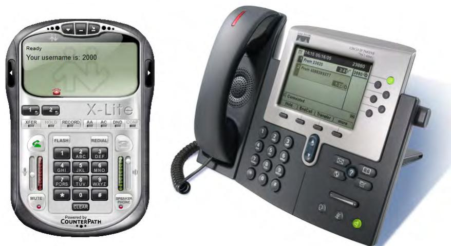
Abbildung 3.11: User Agent in Form eines SIP Softphones (links, X-Lite 3.0) und eines IP-Telefons (Cisco, Quelle<sup>9</sup>)
