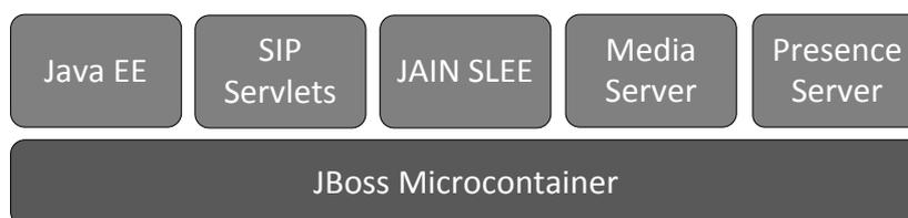
Abbildung 5.14: Die Mobicents Plattform besteht neben dem SIP-Servlet-Container und der JAIN SLEE aus einem Media- und Präsenzserver.
