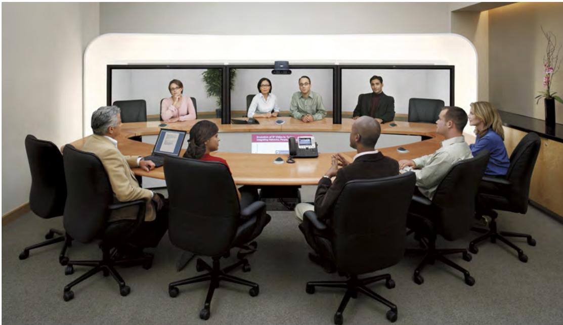
Abbildung 4.14: Videokonferenzsystem von Cisco, ermöglicht die gleichzeitige Wiedergabe von Videobildern der Gesprächspartner (Hintergrund) und die Anzeige einer Präsentation (Bildmitte) (Quelle<sup>6</sup>)
