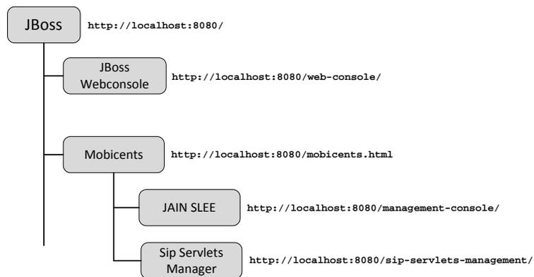
Abbildung 7.5: Management-Konsolen für die Mobicents-Plattform
