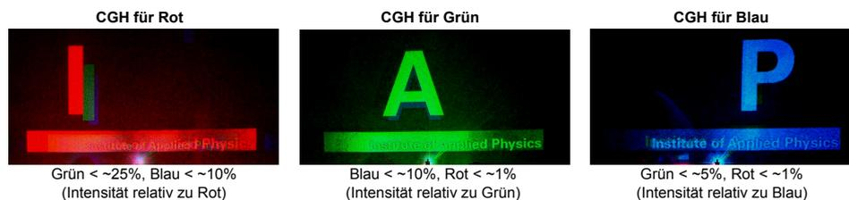
Abbildung 3.11: Erzeugte Bilder bei Beleuchtung eines einschichtigen, wellenlängenselektiven CGH für eine der drei Grundfarben mit allen drei Grundfarben, sowie Messung der relativen Intensität der erzeugten Falschfarbbilder
