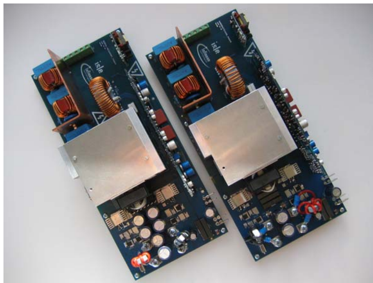
Abb. 5.80 Ansicht der zwei Post-Regulated Schaltnetzteile (v.l.n.r.: SRC/ LLC-Konverter, HSHB-Konverter)
