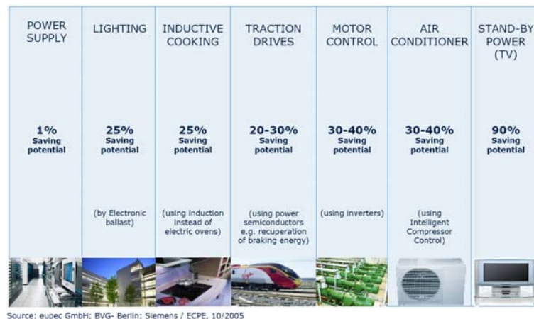
Abb. 1.1 Energieeinsparungspotential durch Leistungselektronik in verschiedenen Anwendungsfeldern (Stand: 2005) [1.5]
