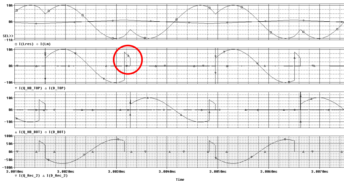
Abb. A. 89 Simulierte Kurvenverläufe des LLC-Konverters mit Synchronegleichrichter im stark unterresonanten Betrieb ( f_{RES}=488 kHz; f_{SW}=298 kHz); (v.o.n.u.: Resonanzdrosselstrom I_{LRES} ; Magnetisierungsstrom I_{Lm} ; Primärschalterstrom high-side-MOSFET I_{Q_{HB\_TOP}} ; Body-Diodenstrom high-side-MOSFET I_{D\_TOP} ; Primärschalterstrom low-side-MOSFET I_{Q_{HB\_BOT}} ; Body-Diodenstrom low-side-MOSFET I_{D\_BOT} ; sekundärseitiger Synchrongleichrichterstrom I_{Q_{Rec\_2}} ; sekundärseitiger Gleichrichterdiodenstrom I_{D\_Rec\_2} ) @ V_{IN}=410 V; R_L=0,67 \Omega (Abb. A. 85)
