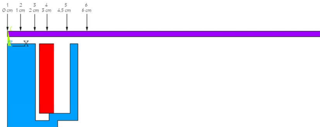
Bild 5. Getesteter Aufbau mit klassischem Induktor (Ferrit, Kupfer, Stahl)
