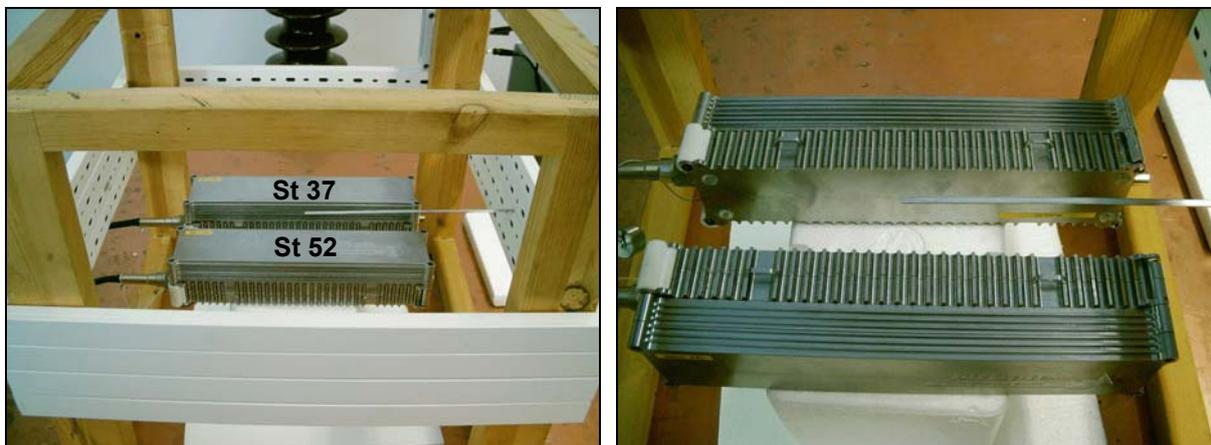
**Abbildung 6: Probe-Positionierung innerhalb der Induktionsspule (li.: flach, re.: hochkant)**
