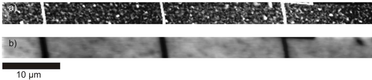
Abbildung 55: a) Topografieaufnahme einer mit Elektronenstrahlolithografie strukturierten Messmarke und b) dazugehörige KPFM-Aufnahme.
