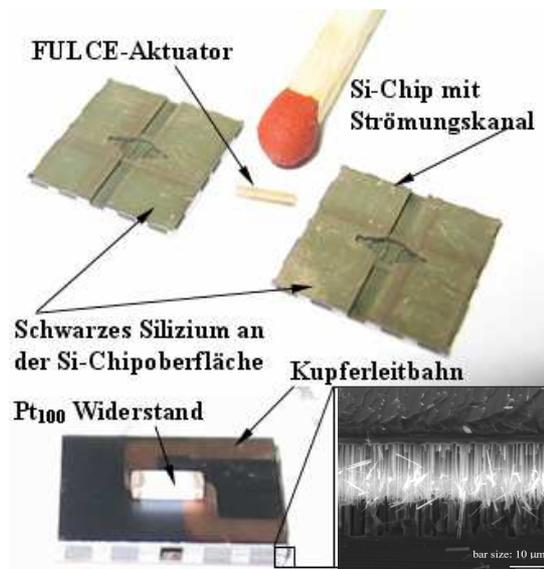
Abbildung 64: Photo der Ventilstruktur, vor (oben) und nach dem Zusammenfügen (unten).
