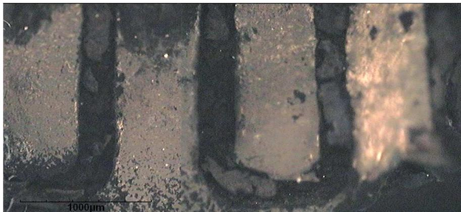
Abbildung 49: Strukturierte leitfähige Russpartikelleitbahn auf einer PDMS-Oberfläche.
