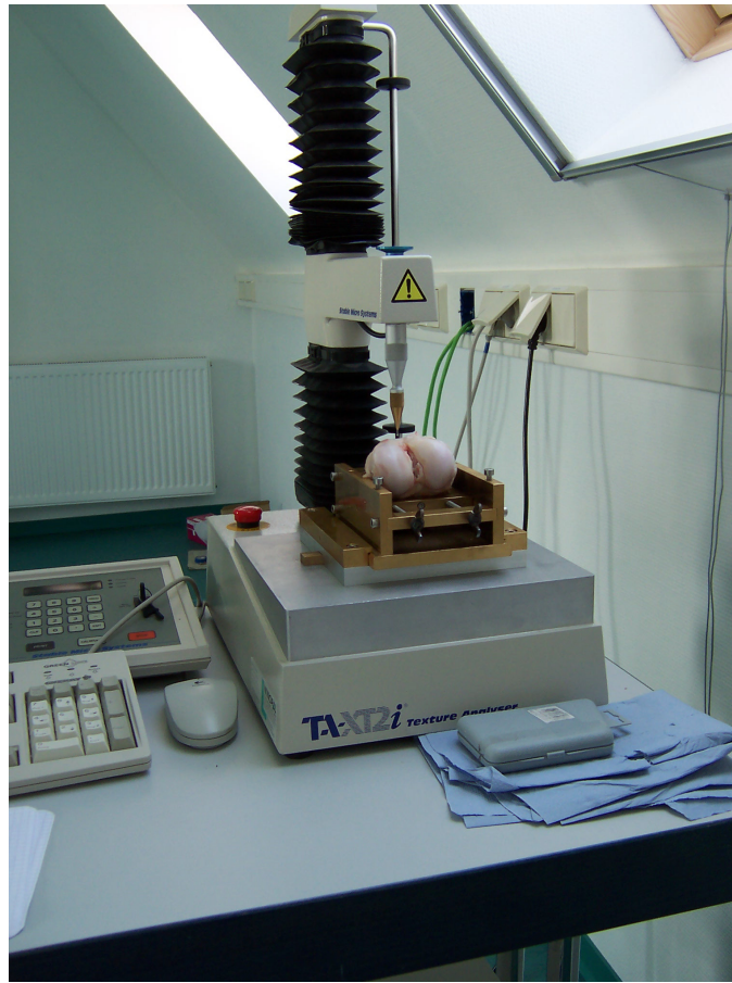
Abb. 3.13: Versuchsaufbau zur Untersuchung des mechanischen Widerstandes von Gelenkknorpel mit Texture Analyser TA-XT2i, Haltevorrichtung und porkinem Kniegelenk
