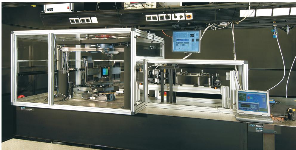
**Abbildung 3.2:** Das Scatterometer. Zusätzlich zur dargestellten Einhausung wurde mittlerweile eine Reinraumzelle mit einer Laminarströmungseinheit aufgebaut. Diese wurde mit einer Stickstoffspülung kombiniert, so dass in einer Stickstoffumgebung unter Reinraumbedingungen gemessen werden kann (Reinraumklasse ISO 3-4 nach ISO 14644-1 [39]).
