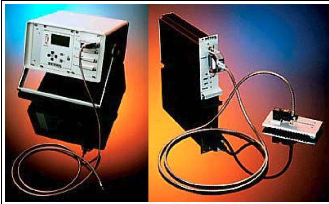
Abb. 66 Sensorspeise- und Verstärkerbausteine DIFOC und ADIF mit angeschlossenen Sensorköpfen (Quelle: TETRA - Gesellschaft für Sensorik, Robotik und Automation mbH , Ilmenau)
