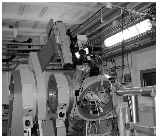
Abb. 4.6.: 6-Kreis-Diffraktometer von ROBL
