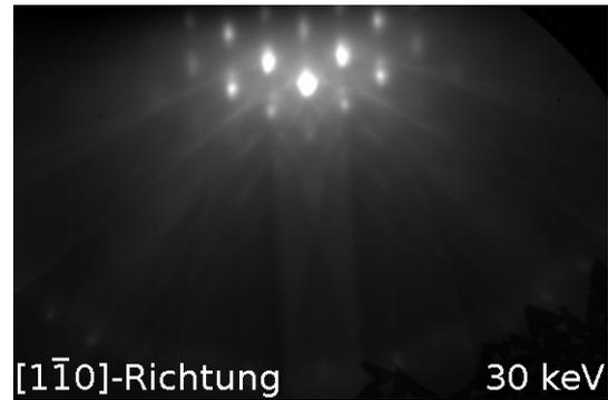
Abb. 5.7.: RHEED-Bild eines Si(001)-Wafers nach S-Terminierung
