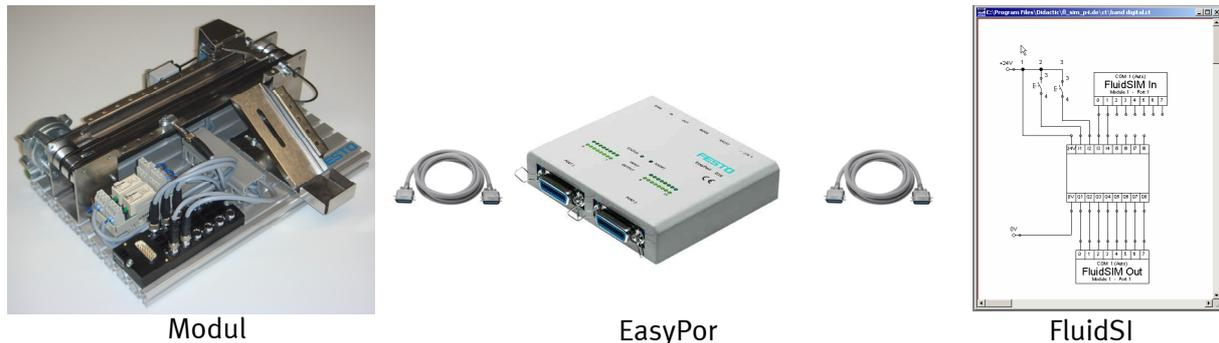
Abbildung 3: Steuerung über PC-Interface und Software FluidSIM
