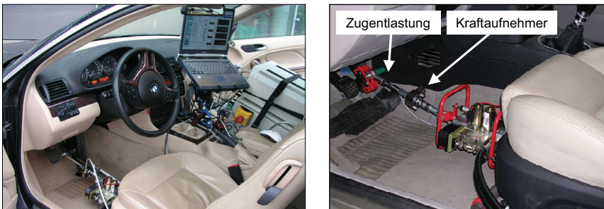
Bild 40: Hydraulische Betätigungsautomatik („Bremsroboter“, links: Prototyp, rechts: überarbeitete Ausführung)
