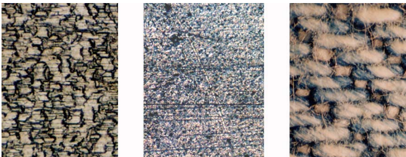
Abbildung 6.18: Aufnahmen der drei Auflageflächen Aluminium (12,5 fach vergrößert), PVC (12,5 fach vergr.), Textiles Gewebe (5 fach vergr., v.l.n.r.).
