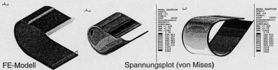
Bild 26: FEM-Berechnungen an einer Kreisbogenfeder vom Typ C aus Federstahl zur Ermittlung der Vergleichsspannung an der Federoberfläche (innen und außen)
