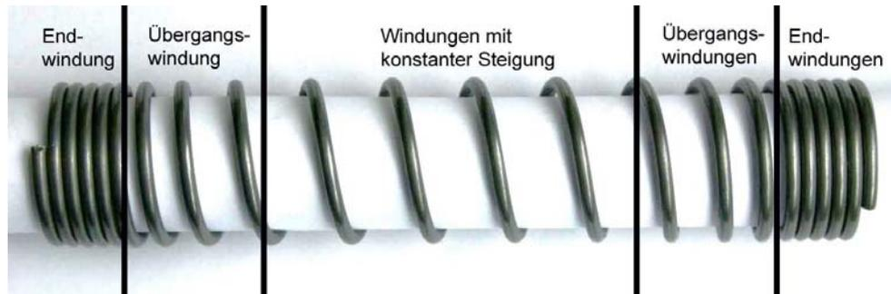
Bild 9: Schraubendruckfeder mit deutlich hervorgehobenen End- und Übergangswindungen [36]
