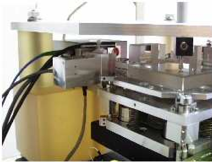
Abb. 3.2: Autokollimationsfernrohr der TU Ilmenau/IPMS, eingesetzt in Nanopositionier- und Nanomessmaschine [Hau02, Sch01]
