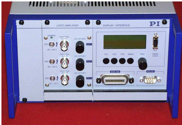
Abb. 5.17: Piezoverstärkereinheit P-503 mit Netzteil und Display-/Schnittstellenmodul in 9,5“-Gehäuse
