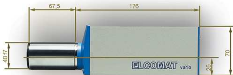
Abb. 3.1: Autokollimationsfernrohr „Elcomat Vario 90“ der Fa. Möller-Wedel Optical GmbH, Wedel [Moe05]
