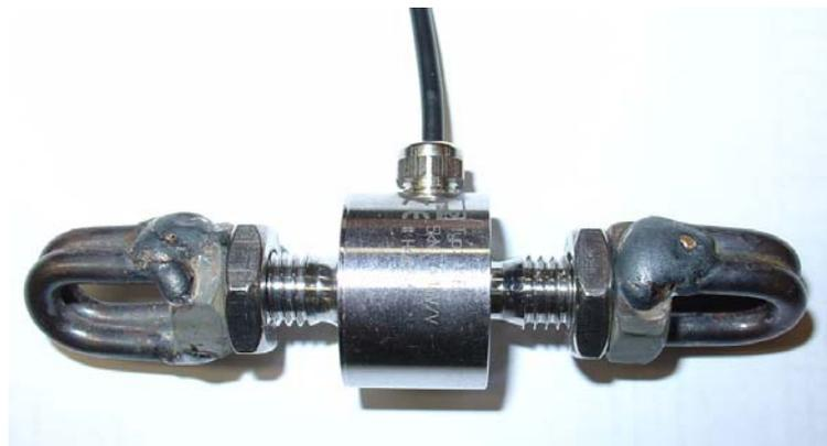
Abb. 8: Zugkraftmessgerät U9B der Firma HBM
