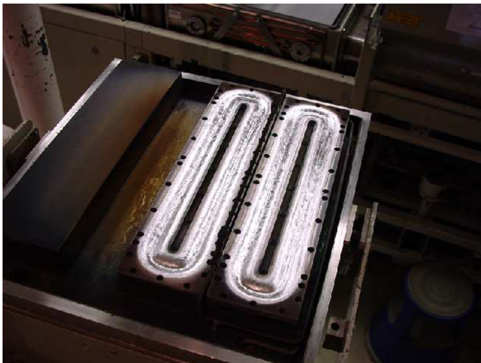
Abbildung 6.2: Versuchsanlage HZS: Magnetronanordnung in Kammer 2
