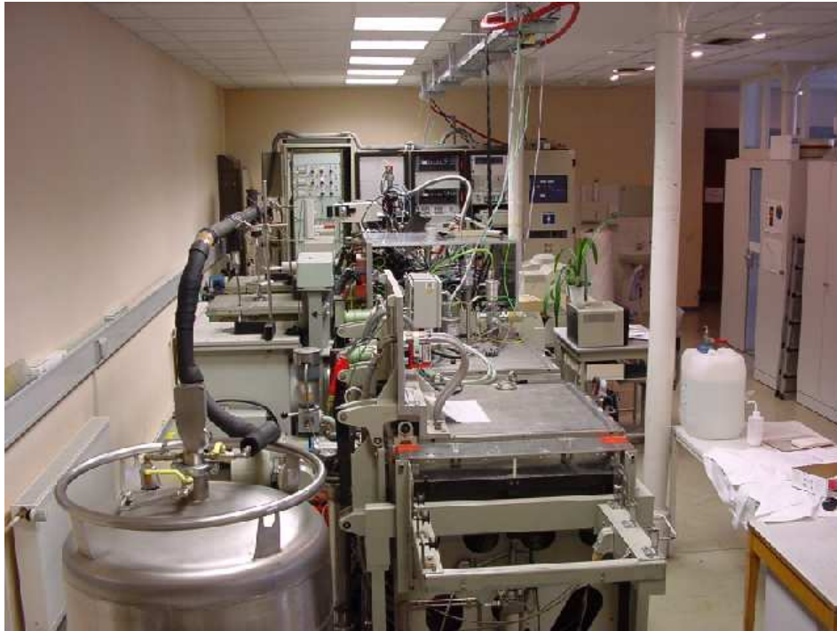
Abbildung 6.1: Versuchsanlage HZS: Anlagengrundkörper mit Einschleuskammer
