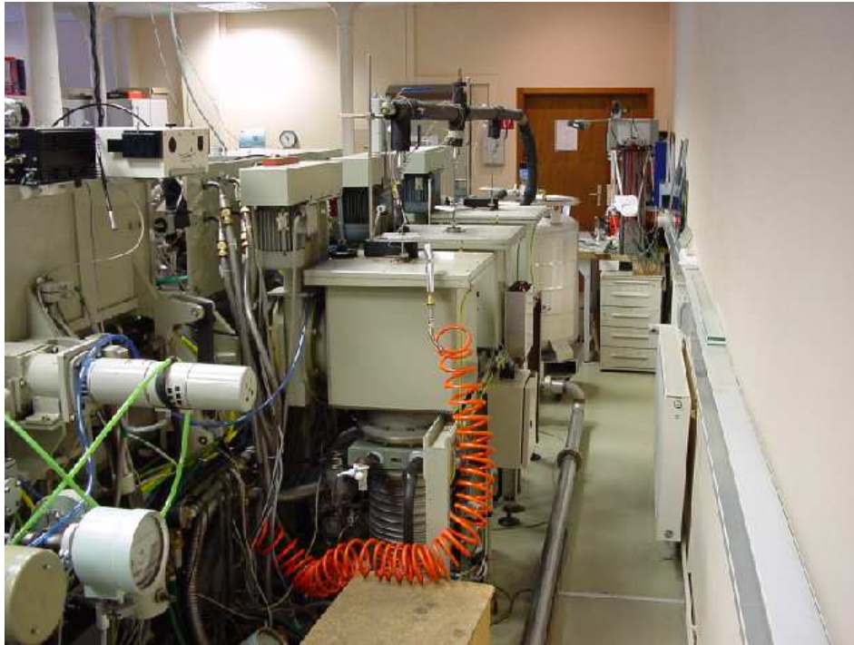
Abbildung 6.4: Versuchsanlage HZS: Kombination aus Öldiffusionspumpe und Kryopumpe
