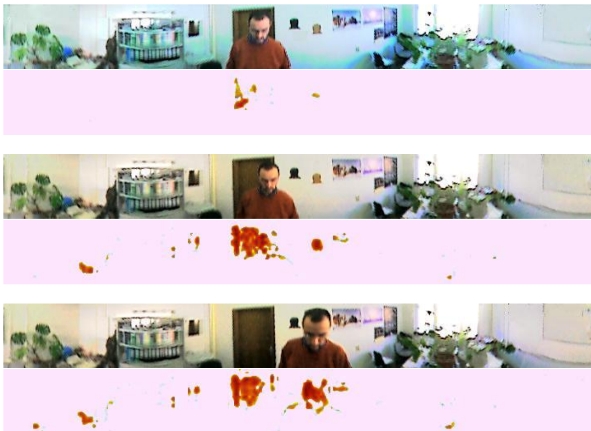
Abbildung A.3: Verbesserte Detektionen des Hautfarbdetektors durch den automatischen Weißabgleich. Es handelt sich um das erste, das fünfte und das zehnte Bild einer Sequenz. Neben der eigentlichen Hautfarbregion entstehen auch mehr falsch-positive Detektionen auf holzfarbenen Objekten.
