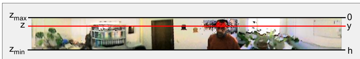
Abbildung 2.22: Zusammenhang zwischen y -Koordinate eines Pixels im Panoramabild und der Höhe z relativ zur Höhe des omnidirektionalen Spiegels. h ist die vertikale Auflösung des Panoramabildes.
