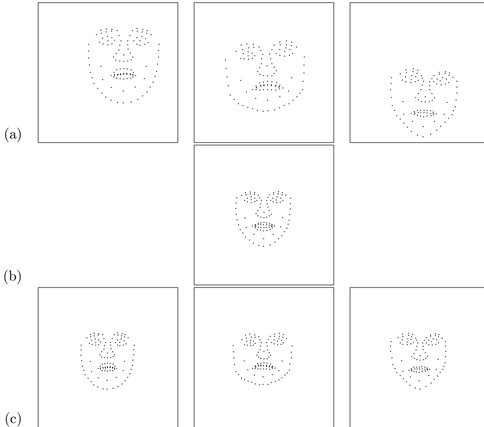
Abbildung 4.31: Beispiele für die Ausrichtung der Formdaten vor der PCA. (a) Originale Labeldaten. (b) Mittelwertvektor nach der Ausrichtung. (c) Die Formen liegen nach der Ausrichtung in ihrem gemeinsamen Schwerpunkt und sind so rotiert und skaliert, dass der mittlere quadratische Fehler zur mittleren Form minimal wird.
