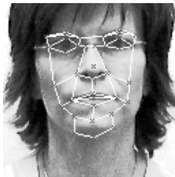
Abbildung 4.8: Trainingsbild mit eingezeichnetem Face-Graph. Die Positionen der Knotenpunkte wurden so definiert, dass sie im Wesentlichen auf markanten Merkmalen liegen, zum Teil aber auch auf homogenen Flächen. Im Gegensatz zu früheren Arbeiten wurden keine Knotenpunkte auf der Außenkontur verwendet, da diese bei der Anpassung des Graphen aufgrund unterschiedlicher Hintergründe oft nicht gut platziert werden konnten.
