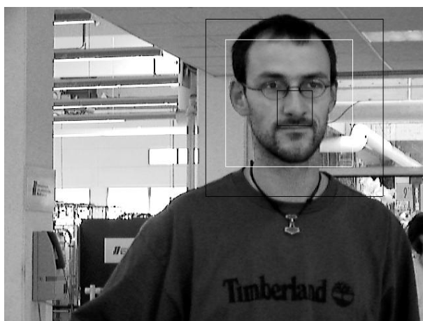
Abbildung 3.12: Auswertung der Gesichtsdetektion. Die beiden schwarzen Rahmen umschließen den Bereich, in dem eine Gesichtsdetektion als positiv gewertet wird, d.h. der vom Gesichtsdetektor gelieferte weiße Rahmen muss sich wie in diesem Beispiel zwischen den beiden schwarzen Rahmen befinden.
