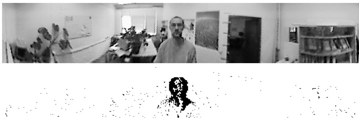
Abbildung 2.11: Panoramabild und zugehörige Ausgabe des Bewegungsdetektors (dunkle Werte stehen für Bewegung). Je nach Schwellwert wird auch Pixelrauschen im Bild als Bewegung detektiert.
