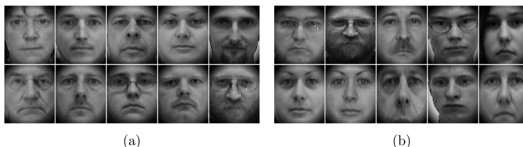
Abbildung 3.16: In (a) wurden die Gesichter anhand von zwei Gesichtsmerkmalen ausgerichtet, d.h. es wurde die selbe Skalierung in x - und y -Richtung verwendet. Es ist deutlich zu erkennen, dass die Positionen der Nasenspitzen und die Münder sehr stark variieren. In (b) wurde anhand der Nasenspitze eine separate Skalierung in y -Richtung bestimmt, so dass die Nasenspitze immer auf die selbe Position im Zielbild platziert werden kann. Da der Abstand vom Mittelpunkt zwischen den Augen zur Nasenspitze von Person zu Person sehr unterschiedlich ist, führt dies zu einer nicht erwünschten Stauchung bzw. Streckung des Gesichtes und zu einer sehr großen Variation in der Position des Mundes.
