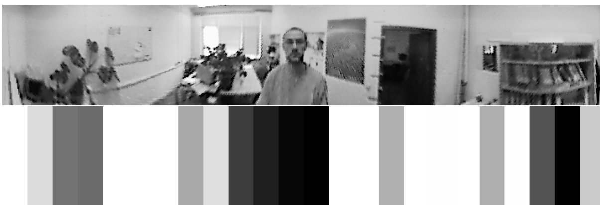
Abbildung 2.13: Panoramabild und zugehörige Sonargewichte (dunkle Werte stehen für Bewegung). Neben der Person befindet sich auch der Schrank auf der rechten Seite in der Nähe des Roboters.
