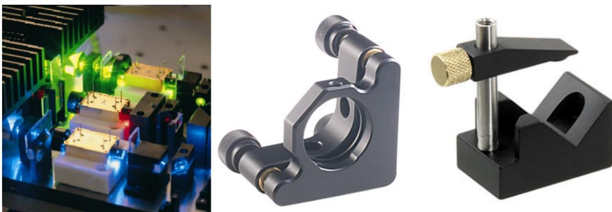
**Bild 6:** RGB-Lasermodul als miniaturisierte, klassische optische Bank (links), Fassungselemente (rechts, [THO-04])
