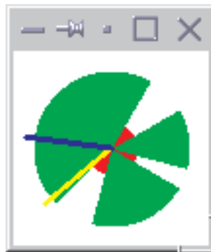
Abbildung 7.46: Sonar-Scan (links) und resultierende Einteilung in freie und belegte Sektoren (rechts). Der hell hervorgehobene Strahl zeigt die Richtung zum globalen Ziel, dunkel ist die resultierende Fahrtrichtung dargestellt.
