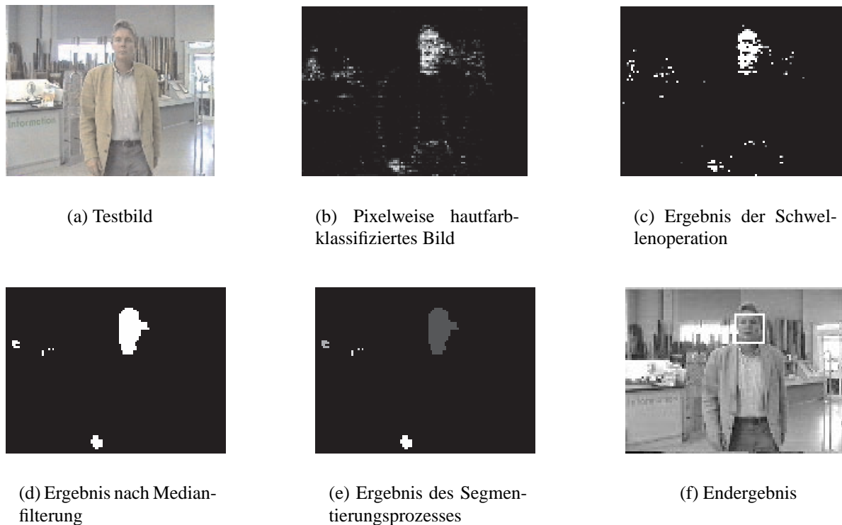
Abbildung 8.6: Ablauf der Hautfarbsegmentierung, dargestellt für eine Ebene der Auflösungs- pyramide (aus [Hem00]).
