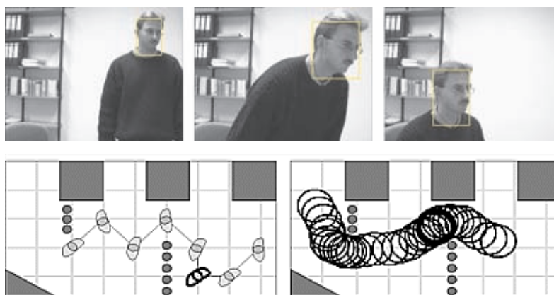
Abbildung 4.14: Ausschnitte aus einer Sequenz zum Personentracking (oben) sowie der Pfad einer Person (unten links), der der Roboter (unten rechts) unter Hindernisvermeidung folgt (entnommen der Webseite des Lehrstuhls für Rechnerarchitektur der Universität Tübingen).
