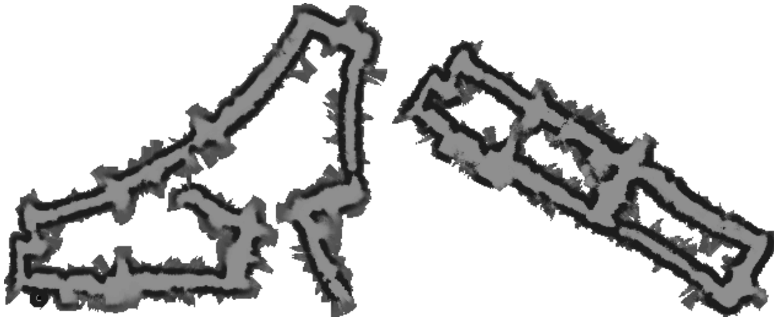
Abbildung 7.18: Karte ohne (links) und mit Odometriekorrektur (rechts), Hindernisse sind schwarz, Freiraum grau und unexplorierte Bereiche weiß dargestellt (nach [BGKW00]).
