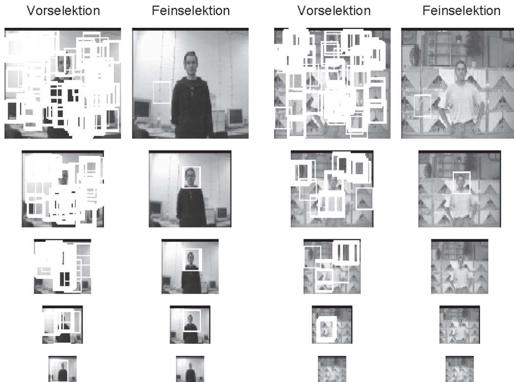
Abbildung 8.9: Illustration des zweistufigen Konturdetektionsverfahrens anhand einer Labor-szene (links) und einer Szene aus der realen BauMarkt-Umgebung (rechts). Zu sehen sind wiederum die verwendeten fünf Auflösungsebenen, die hier einen Entfernungsbereich von 0.5 bis etwa 3m, bezogen auf die Bildebene der Frontalkamera, abdecken.
