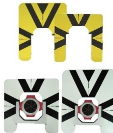
Abbildung 3.5: Anzielhilfen für die Reflektormessung
