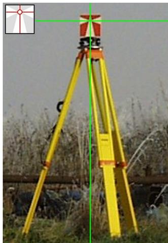
Abbildung 3.4: Markierung eines Messpunktes mit einer Zieltafel
