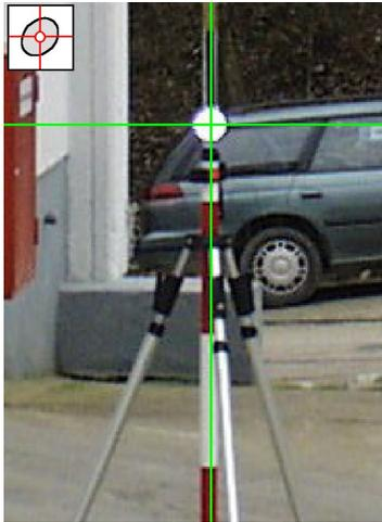
Abbildung 3.1: Markierung eines Messpunktes mit einem Prisma
