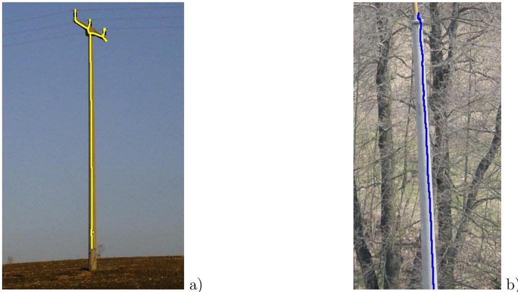
Abbildung 7.25: Bestimmung der mittleren Mastkontur mit „Halcon“
