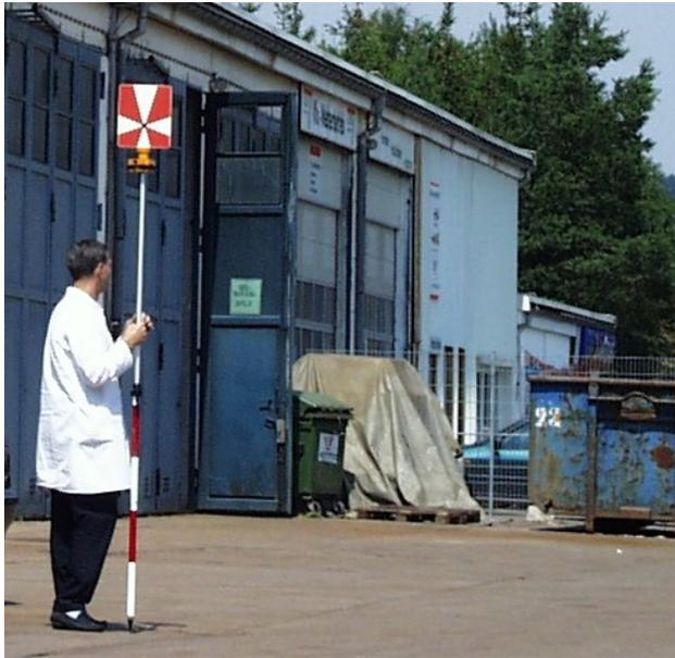
Abbildung 6.6: Markierung eines Messpunktes mit einem Zielmuster höherer Ordnung
