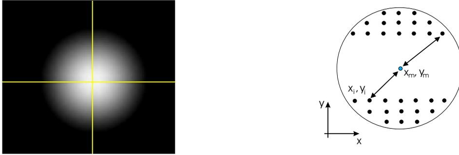
Abbildung 5.3: Modell der automatischen Prismenanzielung
