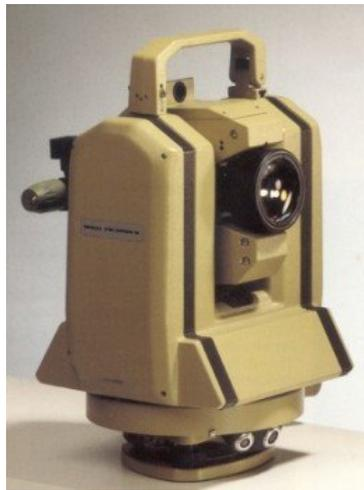
Abbildung 2.3: Videotheodolit TM3000V
