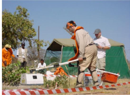
Abb.9: Minensuche mit Hilfe eines Ultra-Breitband-Radars (DEMINE-Projekt)
