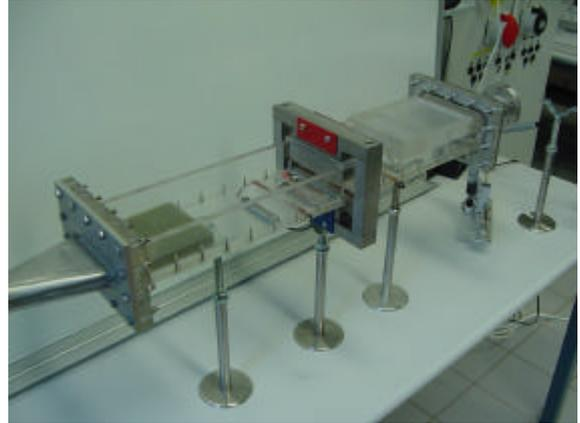
Abb. 31: Flüssigmetallkanal zur Untersuchung der turbulenten Strömung unter dem Einfluss von Magnetfeldern
