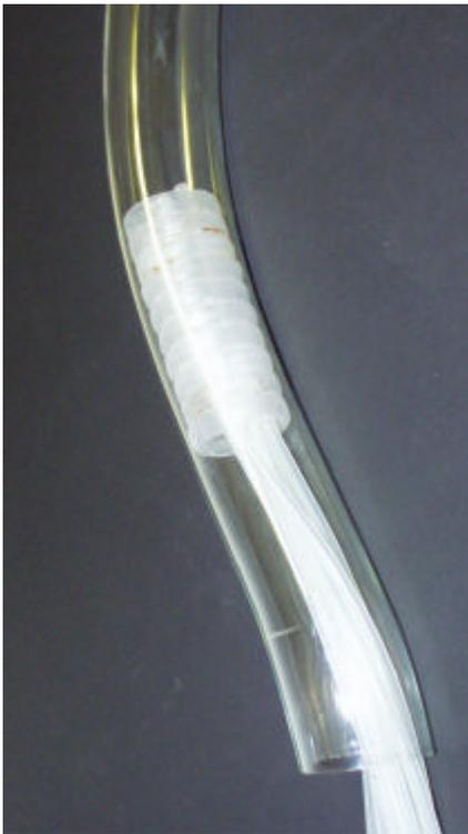
Abb. 33: Makromodell einer Silikonsonde zur Ertestung des Bewegungsprinzips
