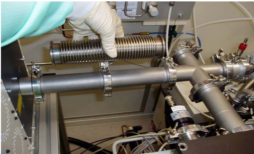
Bild 37: Lösung einer druckabhängigen Justierdifferenz durch Austausch des Well Schlauches
