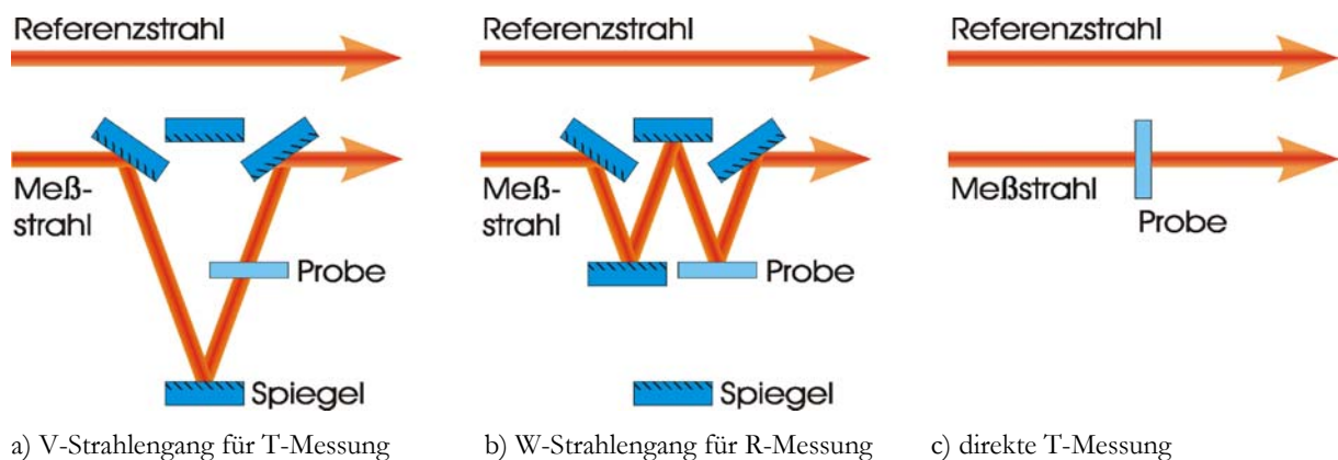
Bild 8: Meßprinzipien beim Strahlengang des Lambda 19
