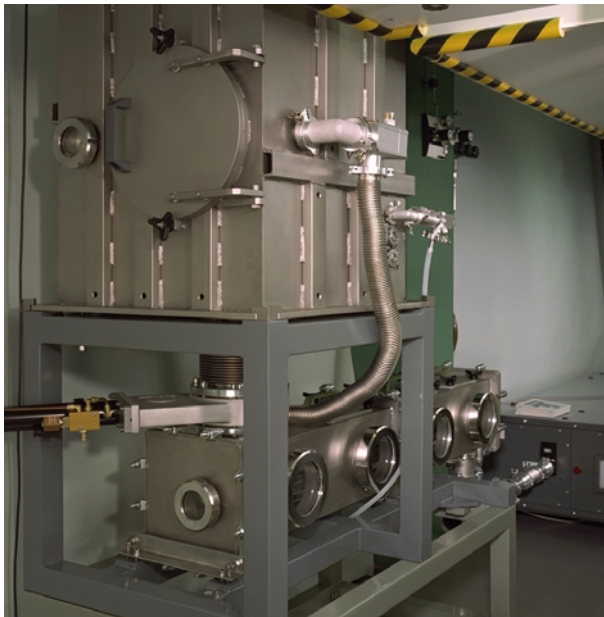
Abb. 4.54: VUV-TS-Vakuumsystem bestehend aus Messkammer (oben) und Strahlkammer (unten)
