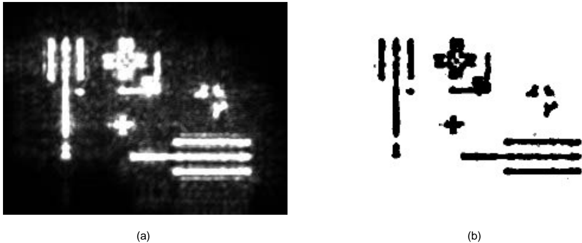
Abbildung 6.9: Ausgangsintensitätsverteilung aus inkohärenter Simulation (a) und ternärisiertes Resistprofil (b) für das multifunktionale Design aus Abbildung 6.8 bei dem Proximity-Abstand d_{\text{prox}} = 50 \mu\text{m}
