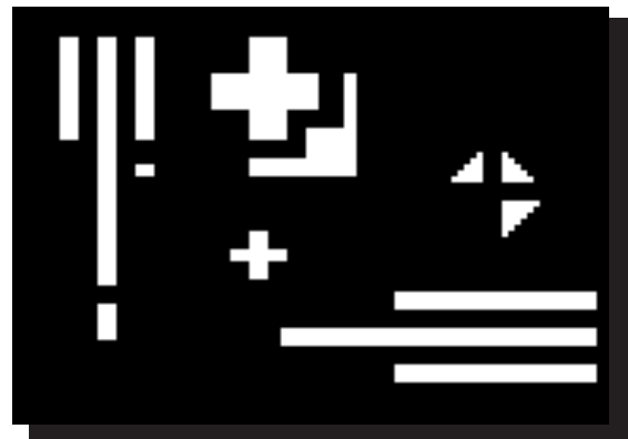
Abbildung 6.2: Betrachtete Zielstruktur mit einer minimalen Strichbreite von 3 \mu\text{m}
