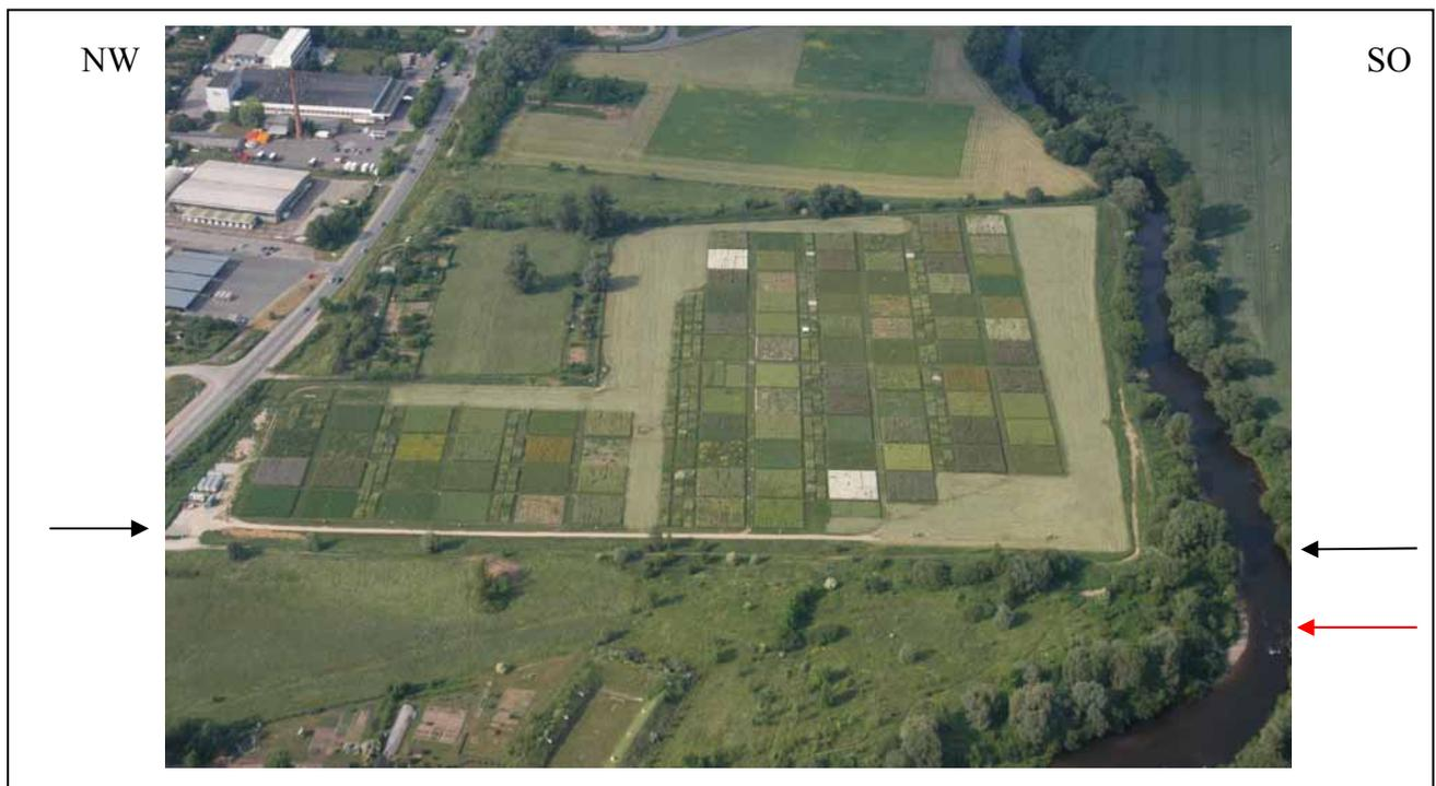
Abb. 3-1 Untersuchungsstandort im Sommer 2003, Pfeile (schwarz) markieren den Verlauf der Pegelgalerie und des geologischen Schnitts in Abb. 3-2 Pfeil (rot) markiert die Lage des ehemaligen Wehrs
