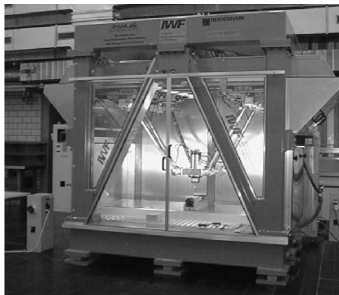
Bild 2.3 Parallelkinematische Werkzeugmaschine Hexaglide. Quelle: [www2].
